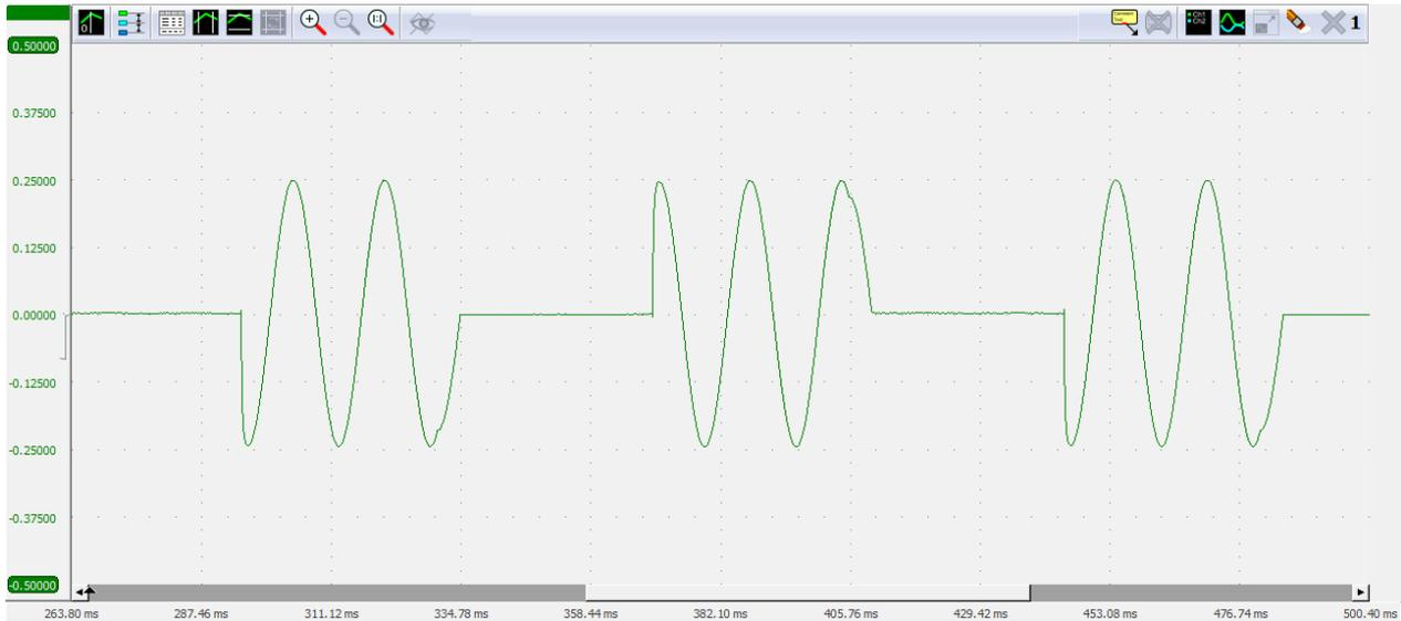
Jeder SCR/Thyristor ist ein Schaltgerät, das schnelle AC-Vollwellen oder Leistung im Phasenanschnitt an einen Verbraucher liefern kann. Der AKGrad32 führt eine ausgewogene Leistungsregelung mit höchster Genauigkeit für ihren Heizprozess durch. Gleichzeitig garantiert es eine optimierte Lebensdauer des Heizelements nach den Vorgaben verschiedener Heizelementhersteller.
