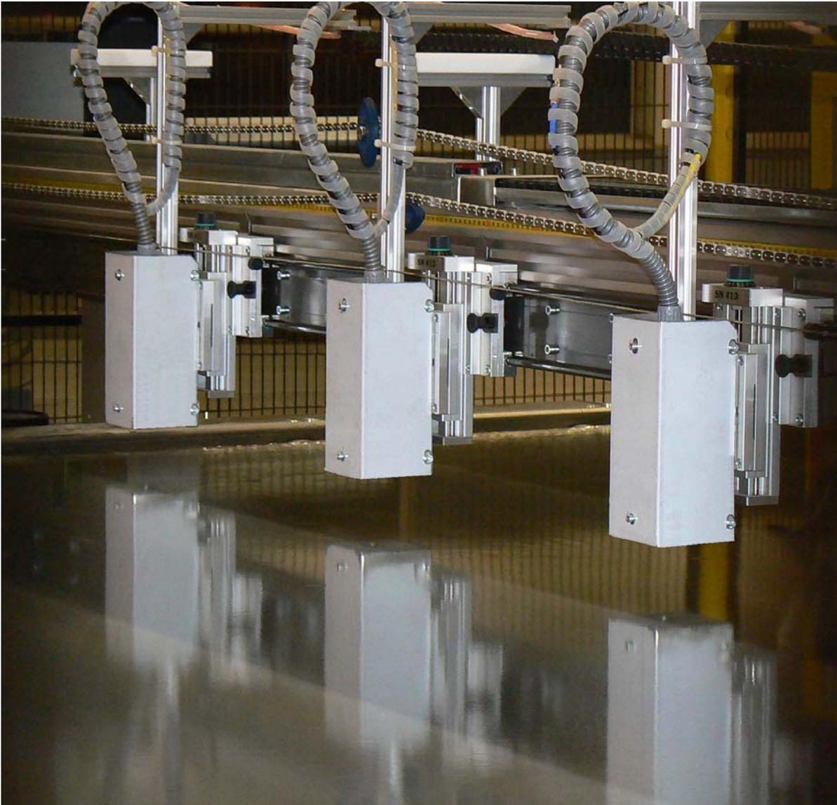
Medición de espesores de vidrio en líneas laminadoras de vidrio (solar)
