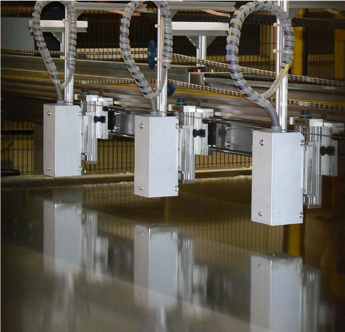
Misurazione di spessore del vetro su linee del vetro laminato (solare)
